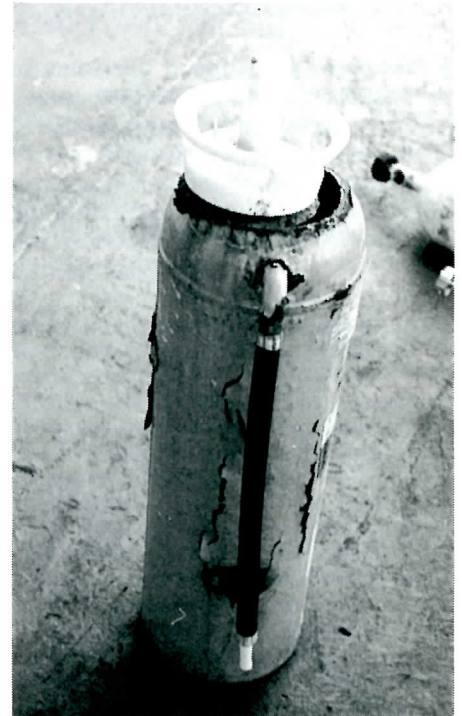
een volledig onbruikbaar brandblusapparaat
